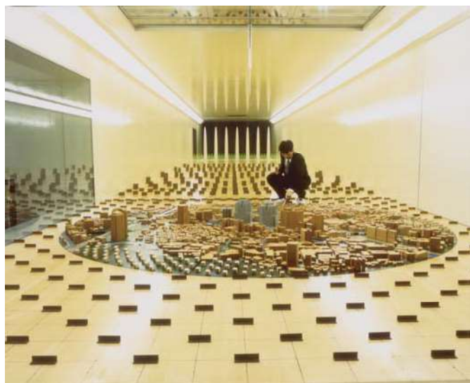
<鹿島建設 大型境界層風洞> 測定胴内部 (幅4.5m)
