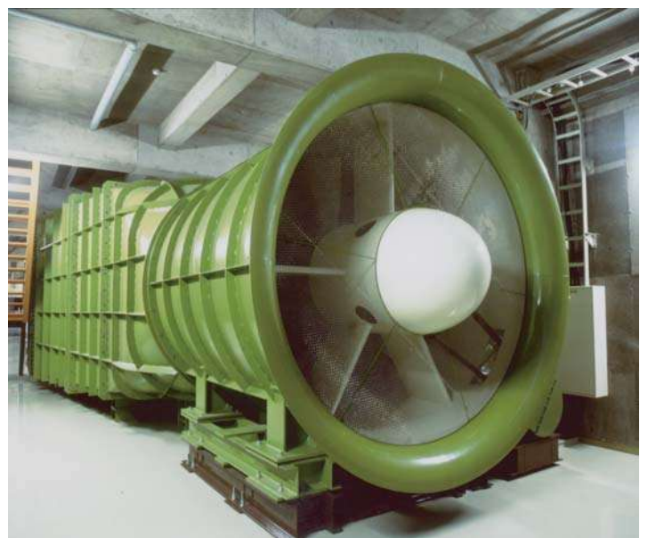
<日本大学生産工学部 境界層風洞> 軸流送風機
