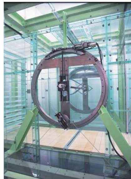
▲強制振動実験用模型加振装置 傾斜角可変の大口徑リングにバネ支持装置，自由振動実験用模型加振装置・減衰装置，非定常・定常空気力測定装置等を設置可能です
