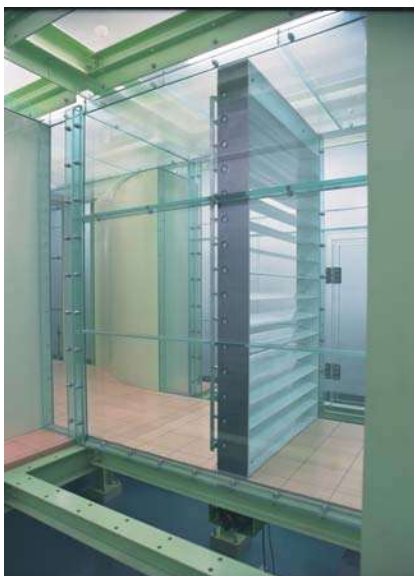
▲周期変動流発生装置(A) 可変翼の正弦波加振により鉛直方向変動気流を発生します
