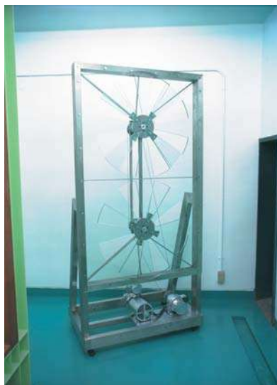
▼周期変動流発生装置(B) 回転翼と開口パネルにより主流方向変動気流を発生します
