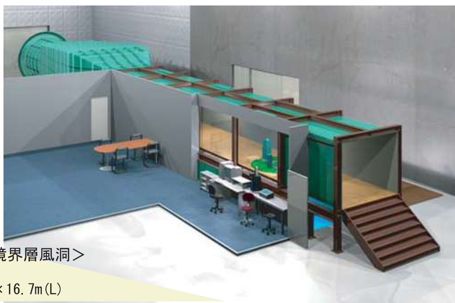
<高知工科大学 エッフェル型風洞> 風速：0.5~13m/s 測定胴：0.8m(W) × 1.25m(H) × 3.5m(L)
